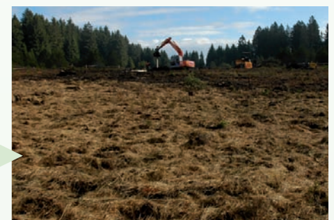
Gewinnung von stärker zersetztem Torf aus tieferen Schichten. Die Vegetation wird sorgfältig abgetragen und als Schutz auf dem durch die Torfentnahme tiefer gelegten und entblösten Torfkörper aufgebracht
