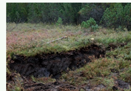
Gewinnung von stärker zersetztem Torf aus tieferen Schichten. Die Vegetation wird sorgfältig abgetragen und als Schutz auf dem durch die Torfentnahme tiefer gelegten und entblösten Torfkörper aufgebracht
